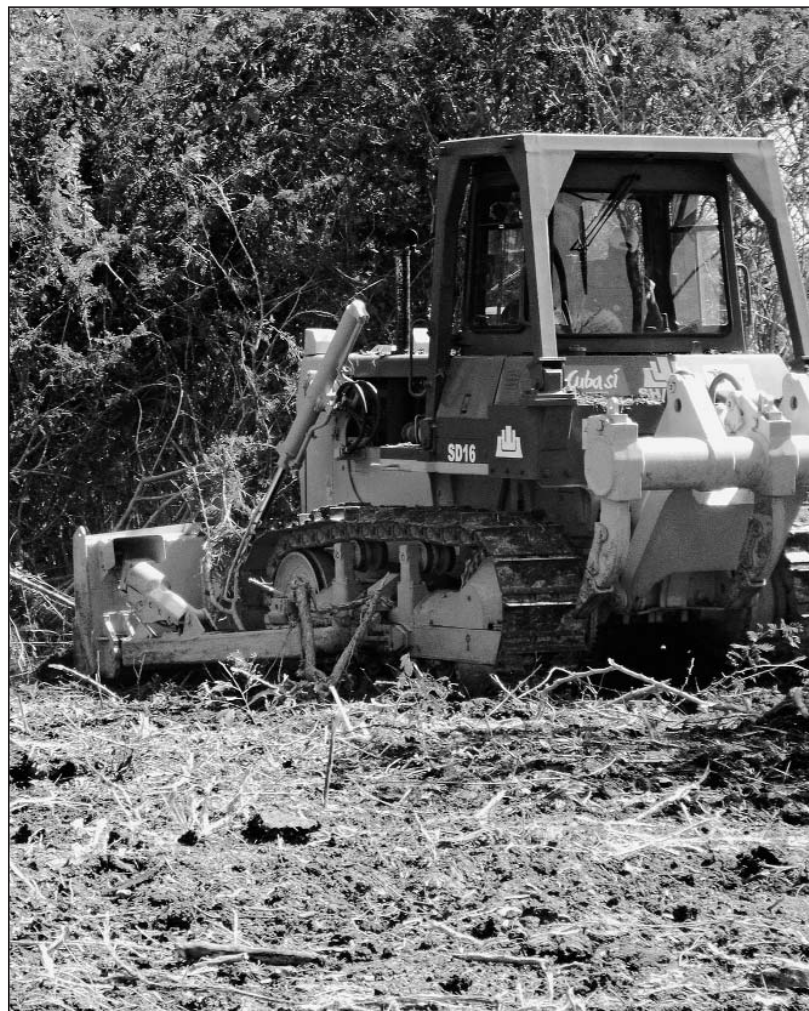
Der Cuba-Sí-Bulldozer knickt mit der Schaufel die Marabú-Stämme ab und zieht anschließend mit den Greifern die tiefliegenden Wurzeln aus der Erde. Foto: Cuba Si
